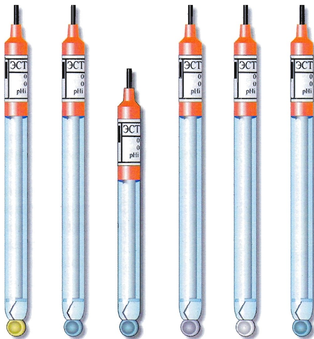
Рис.1. Фотография внешнего вида электродов стеклянных твердоконтактных ЭСТ.
