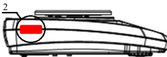
Рисунок 2 – Место нанесения заводского номера, знака поверки, знака утверждения типа (1); место пломбировки от несанкционированного доступа: разрушаемая наклейка (2).
